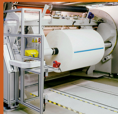
WENDEANTRIEB FÜR WICKLER IN BESCHICHTUNGSANLAGEN
