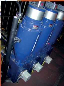
BÜHNENTECHNIKANTRIEBE Z.B. AUF KREUZFAHRTSCHIFFEN
