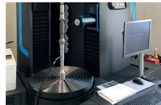
3D KLINGELNBERG VERZÄHNUNGSMESS- MASCHINE
