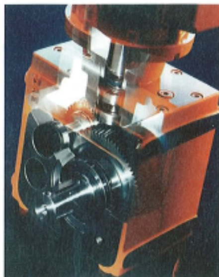
Bild 2: Getriebe werden auf Basis von Funktionsprüfungen optimiert
