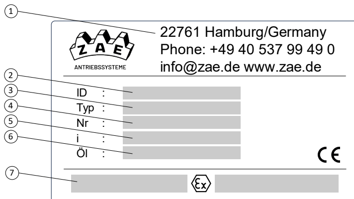
Bild 3.2: Typenschild für den Einsatz im explosionsgefährdeten Bereich
